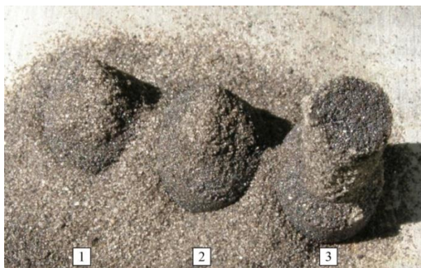
Рис. 1. Экспериментальные образцы песчано-смоляных литейных стержней после термической обработки при различных массовых долях органического связующего вещества – эпоксидно-диановой смолы марки ЭД-20: 1 – 1,5 мас. %; 2 – 2,0 мас. %; 3 – 3,0 мас. %
