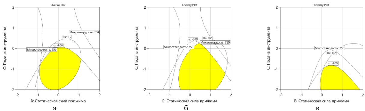
Рис. 7. Совмещенные контурные кривые поверхностей равного отклика: а – A = -1 ; б – A = 0 ; в – A = +1 Fig. 7. Combined contour curves of surfaces of equal response: а is A = -1 ; б is A = 0 ; в is A = +1
