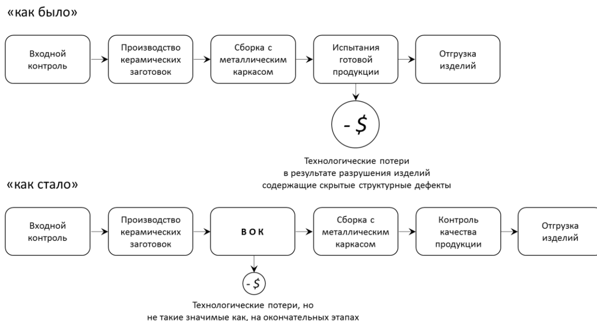
Рис. 4. Схема влияния третьей инновации на процесс изготовления изделий (составлено авторами) Fig. 4. Scheme of the influence of the third innovation on the manufacturing process (compiled by the authors)
