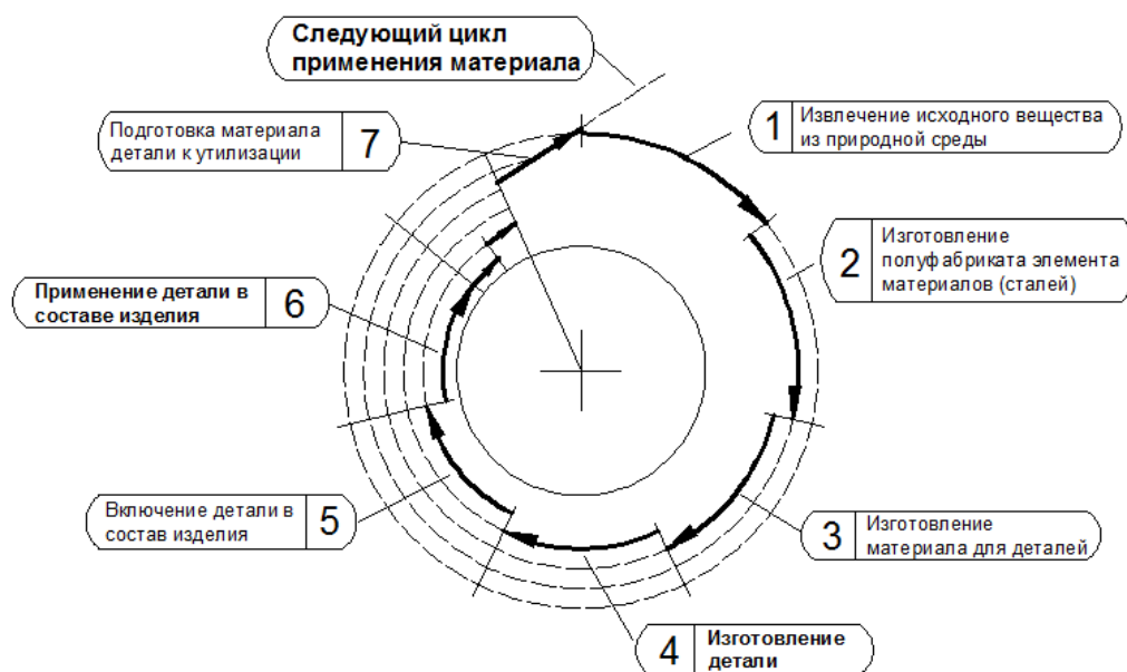
Рис. 1. Схема цикла использования природных веществ для изготовления и применения деталей машин Fig. 1. Cycle scheme of using natural materials for the production and use of machine parts
