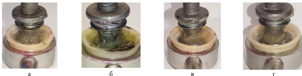
Рис. 6. Фотографии образцов после проведения испытания: а – старая конструкция по стандартной методике; б – старая конструкция по модернизированной методике; в – модернизированная конструкция по стандартной методике; г – модернизированная конструкция по модернизированной методике
