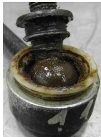
Рис. 2. Внешний вид зарекламованного шарнира стойки стабилизатора
