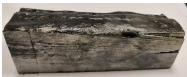
Рис. 1. Характерный вид наплавленного сплава системы Co-Cr-Fe-Mn-Ni Fig. 1. Characteristic view of the deposited alloy of the Co-Cr-Fe-Mn-Ni system
