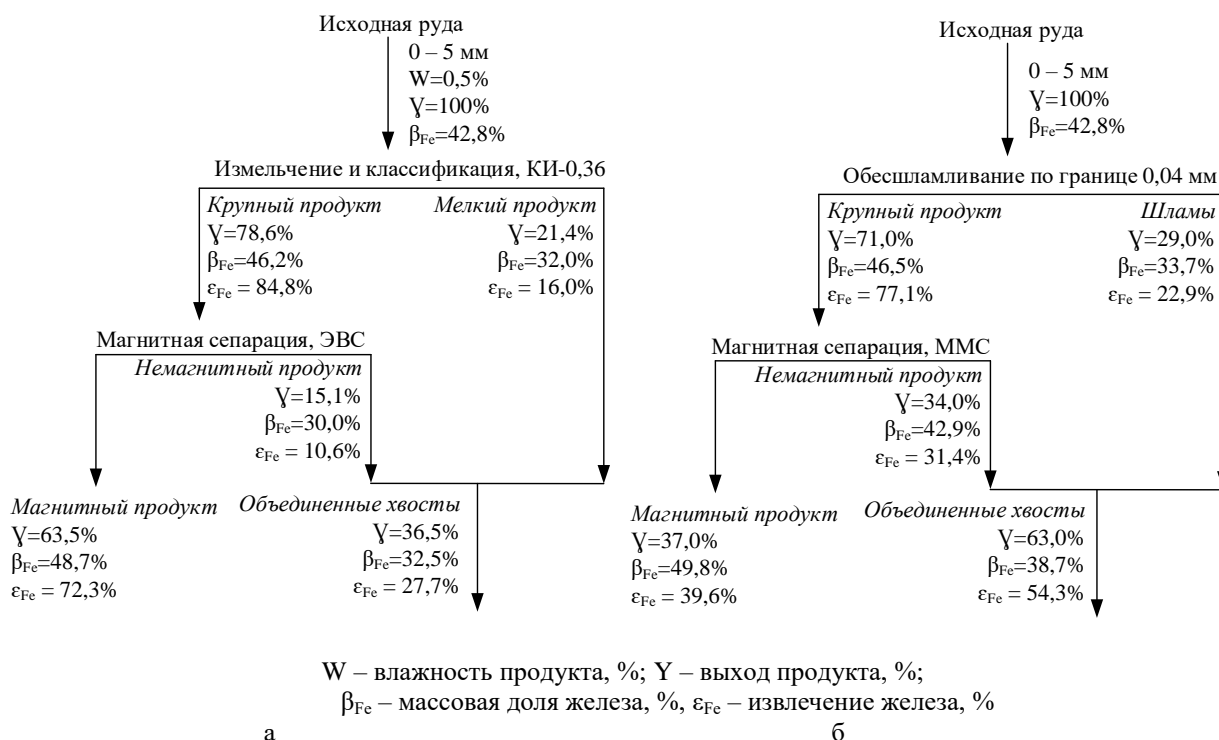
Рис. 5. Показатели переработки бурожелезняковой руды по схемам сухого (а) и мокрого (б) обогащения Fig. 5. Indicators of processing of brown clay iron ore according to dry (a) and wet (b) enrichment schemes
