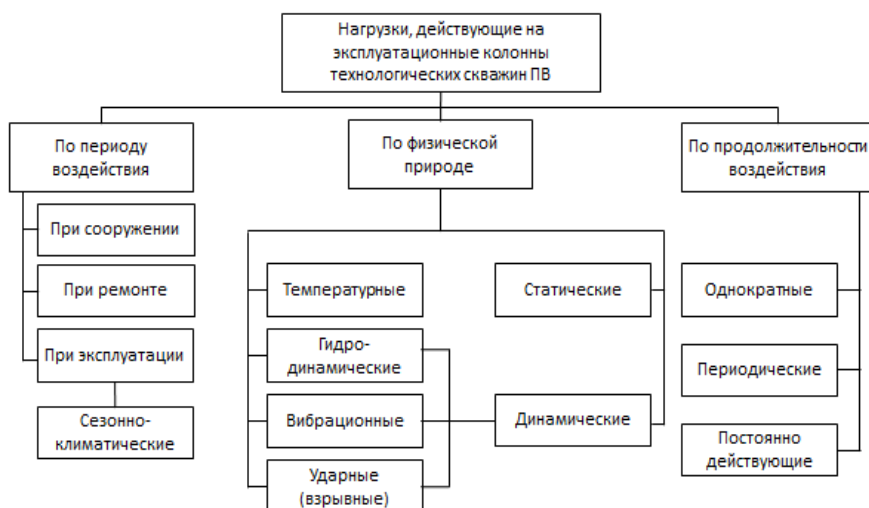
Рис. 2. Классификация нагрузок, действующих на эксплуатационную колонну технологической скважины СПВ-урана
