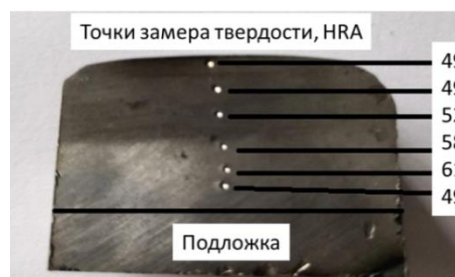
Рис. 2. Результаты замера твердости исследуемого образца Fig. 2. Results of measuring the hardness of the test sample
