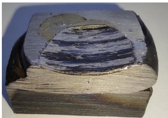
Рис. 5. Фото образца системы Co-Cr-Fe-Mn-Ni после проведения испытания на износостойкость
