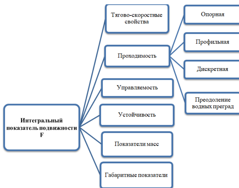
Рис. 2. Структура верхних уровней иерархии интегрального показателя подвижности вездеходной техники Fig. 2. Structure of the upper levels of the hierarchy of the integral index of mobility of all-terrain vehicles
