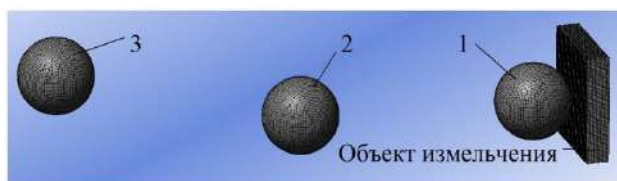
Рис. 14. Трехмерная модель для реализации процесса измельчения: 1, 2, 3 – порядковые номера молотков
