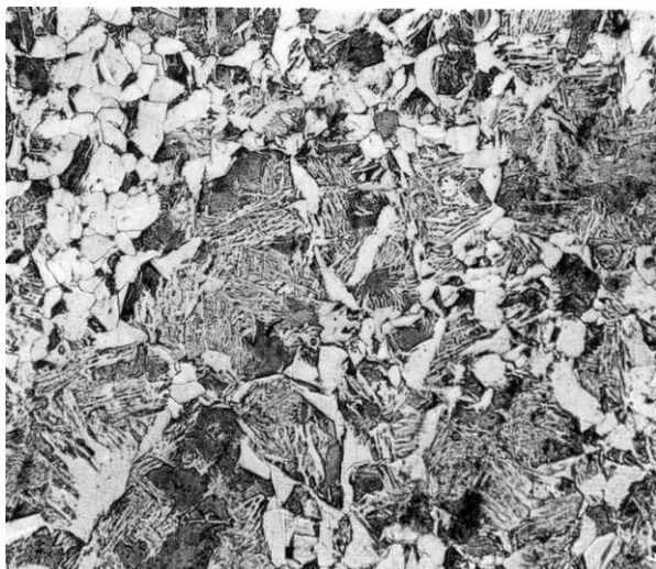
Рис. 5. Микроструктура участка средней зоны арматурного проката №6 из стали Ст3Гсп с бором (режим обработки 3.1 с T_{\text{во}} = 920^{\circ}\text{C} ), \times 800
