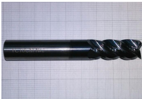
Рис. 6. Опытный образец фрезы и измерение фаски износа Fig. 6. Pilot milling cutter and chamfer wear measurement
