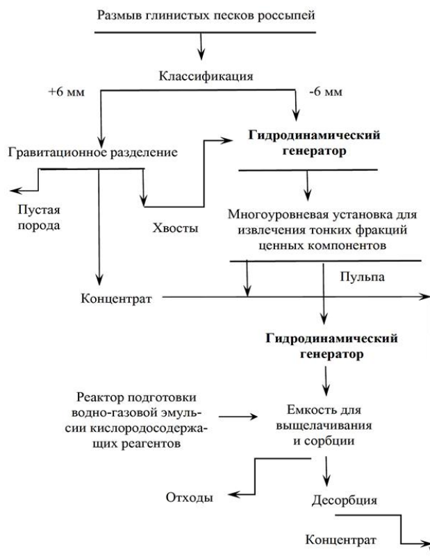
Рис. 1. Технологическая схема переработки высокоглинистых россыпей с мелким золотом Fig. 1. The process flow chart of processing high-clay placers with fine gold
