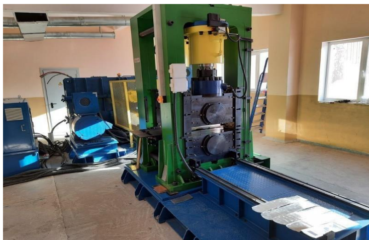
Рис. 1. Реверсивный стан дуо листовой прокатки с индивидуальным приводом рабочих валков Fig. 1. Reversing two-high rolling mill with individually driven work rolls
