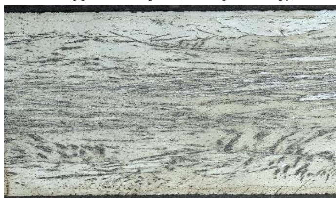
Рис. 6. Строение углеродосодержащей фазы в образце №2 (растровая микроскопия) Fig. 6. Structure of the carbon-containing phase in sample 2 (scanning microscopy)
