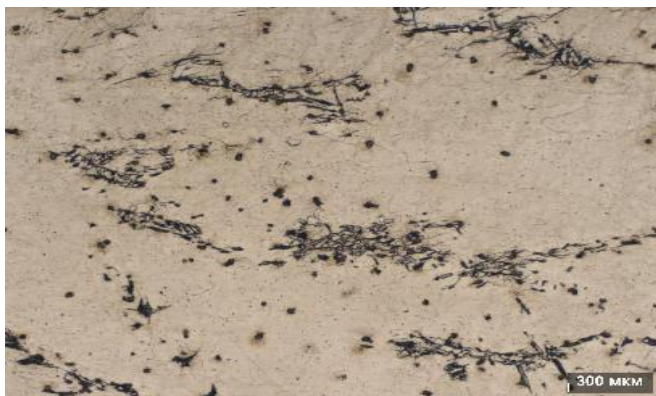
Рис. 5. Очаги рекристаллизации в образце №2 (оптическая микроскопия)
