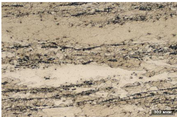
Рис. 8. Структура сердцевины образца №3 (оптическая микроскопия)
