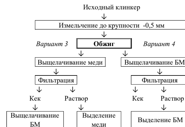
Рис. 2. Схема экспериментов с предварительным удалением коксика Fig. 2. Scheme of experiments with preliminary removal of coke breeze
