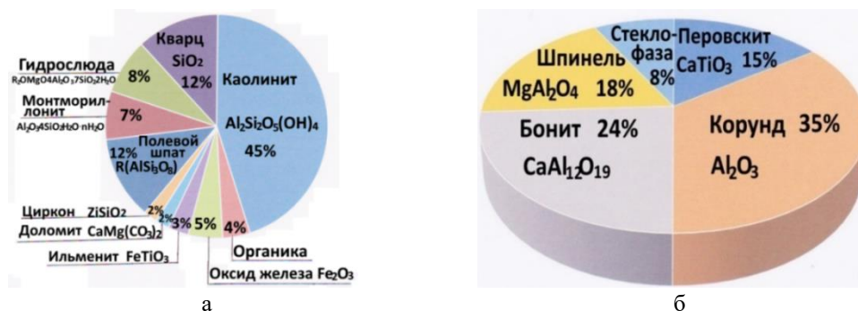
Рис. 2. Минералогический состав отходов производств: а – ГЦИ; б – шлак от выплавки ферротитана Fig. 2. Mineralogical composition of industrial waste: a is GZI; б is ferrotitanium slag
