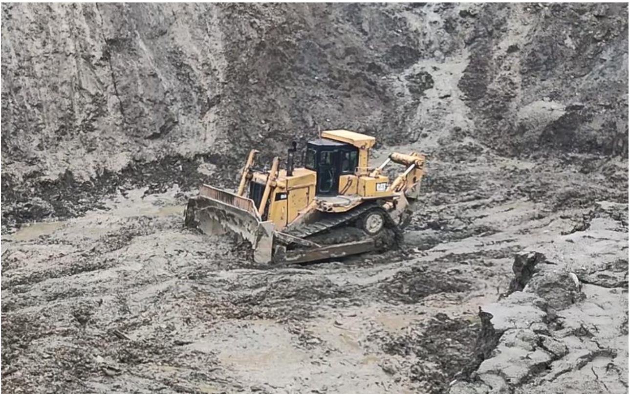
Рис. 2. Пример работы бульдозера CAT D9R в обводнённом забое Fig. 2. Operation of bulldozer CAT D9R in a watered face (for reference)
