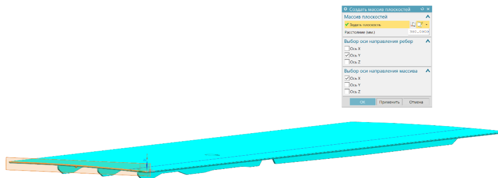
Рис. 11. Построение массива плоскостей перпендикулярно линии построения ребер Fig. 11. Building an array of planes perpendicular to the edge construction line
