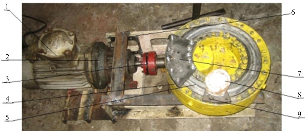
Рис. 2. Установка непрерывного литья-прессования методом conform
