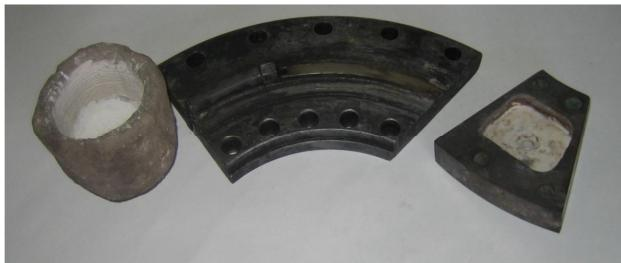
Рис. 3. Дозатор, башмак и площадка дозатора
