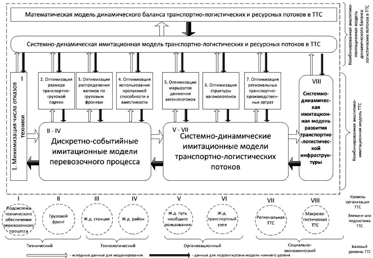
Рис. 2. Схема взаимосвязи блоков комбинированной аналитико-имитационной модели ТТС
