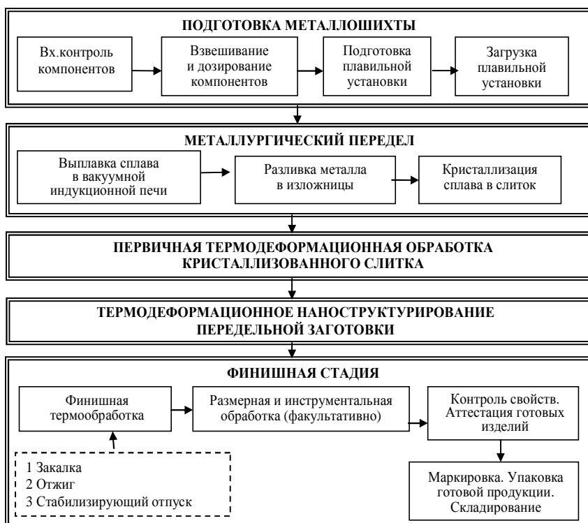
Рис. 4. Базовая технологическая схема изготовления наноструктурированных заготовок из высокопрочных многофункциональных сплавов со специальными свойствами
