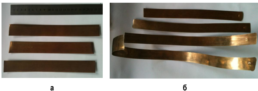
Рис. 3. Образцы латунной ленты до деформации (а) и после асимметричной прокатки (б)
