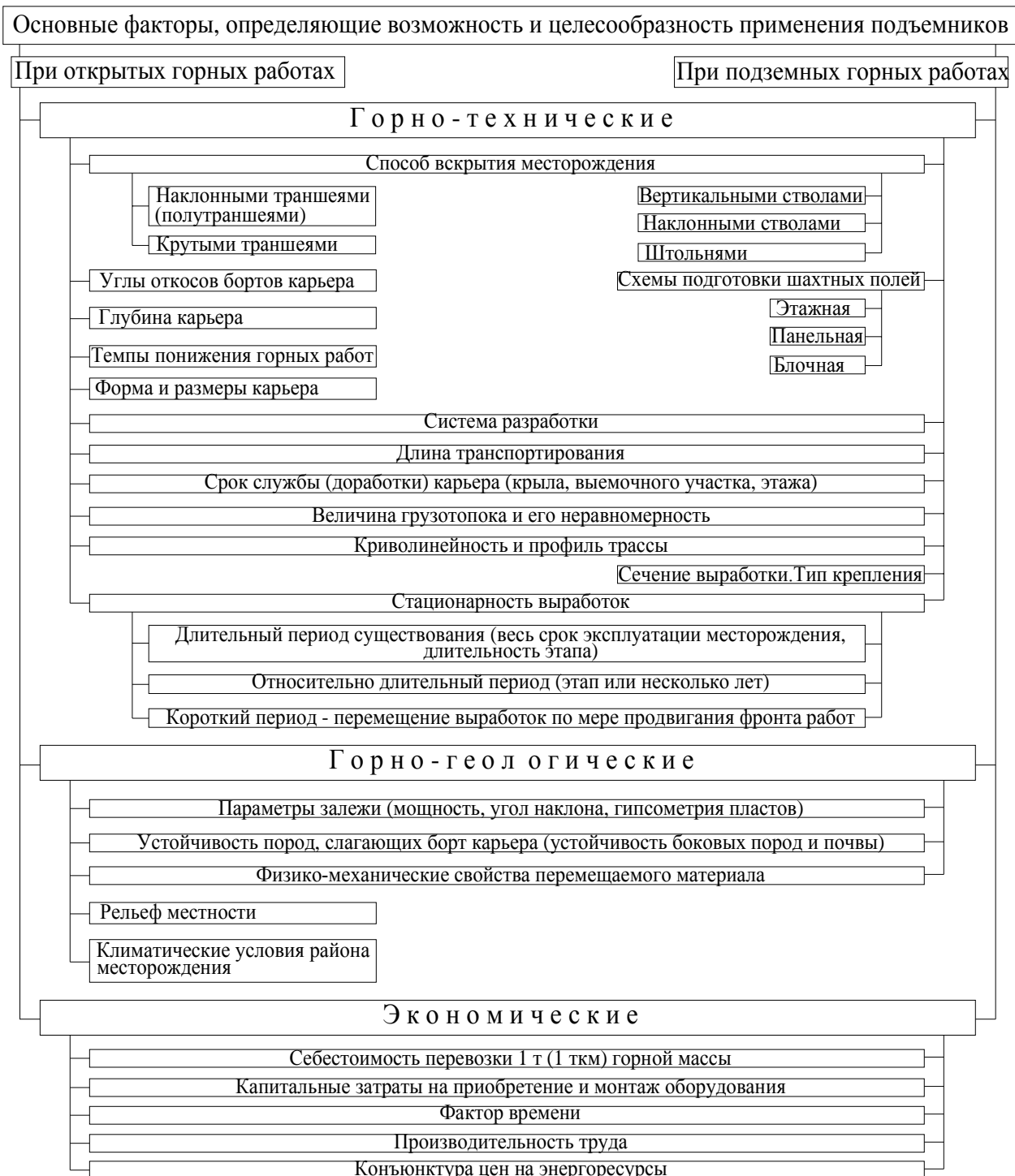
Рис. 6. Факторы, определяющие возможность и целесообразность применения подъемников при открытых и подземных горных работах
