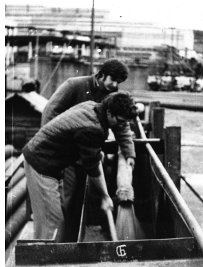
Рис. 3. Процесс намыва ограждающей дамбы хвостохранилища на модельной установке
