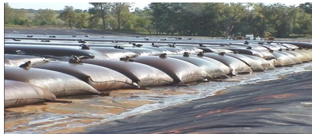
Рис. 2. Процесс обезвоживания пульпы
