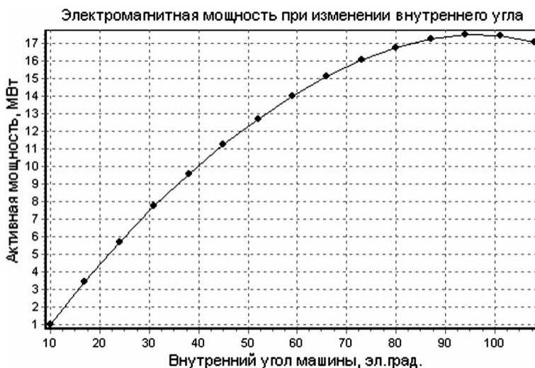
Рис. 2. Зависимость электромагнитной мощности генератора Г4А (ЦЭС) от его внутреннего угла
