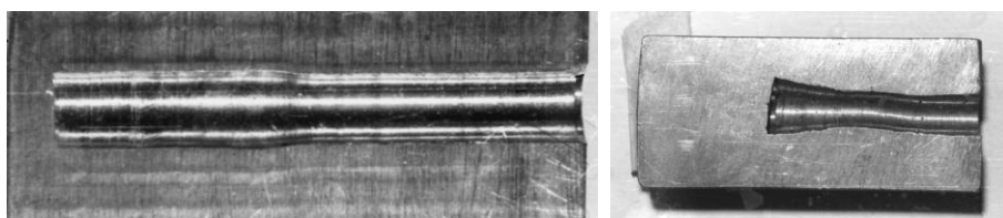
Рис. 2. Управление точностью сверления отверстий: а – размера; б – продольной формы
