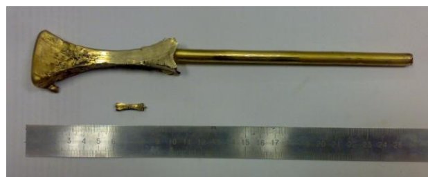
Рис. 5. Виды недокатов и пресс-изделий, полученных методом совмещенной обработки сплава ПСР-40
