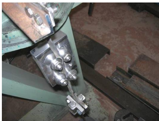
Рис. 10. Деформирующая головка для продольного изгиба полосы
