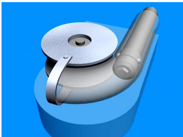
Рис. 1. Схема гибки труб с раскатыванием
