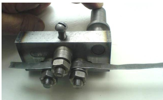
Рис. 8. Роликовая вальцовка экспериментальной установки
