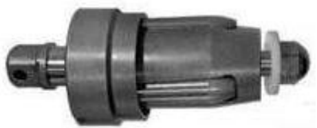
Рис. 9. Роликовая раскатка с 3-мя деформирующими роликами
