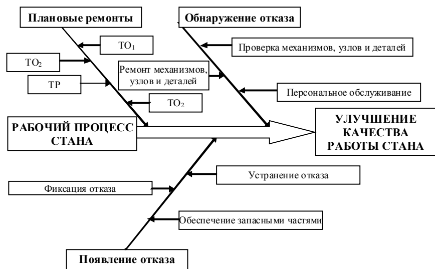
Рис. 1. Диаграмма Исикавы, отражающая процесс работы стана-2500 г.п. ЛПЦ-4 ОАО «ММК»
