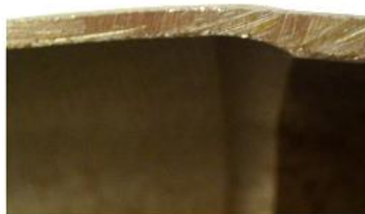
Рис. 8. Поперечное сечение внешней стенки изогнутой трубы в разрезе
