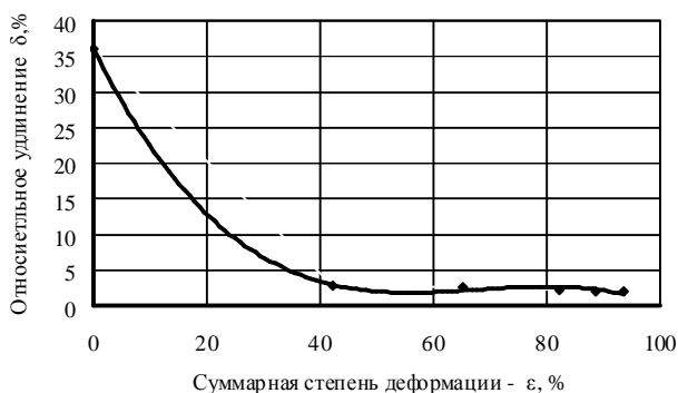
Рис. 3. Относительное удлинение экспериментального сплава палладия при растяжении в зависимости от степени холодной деформации
