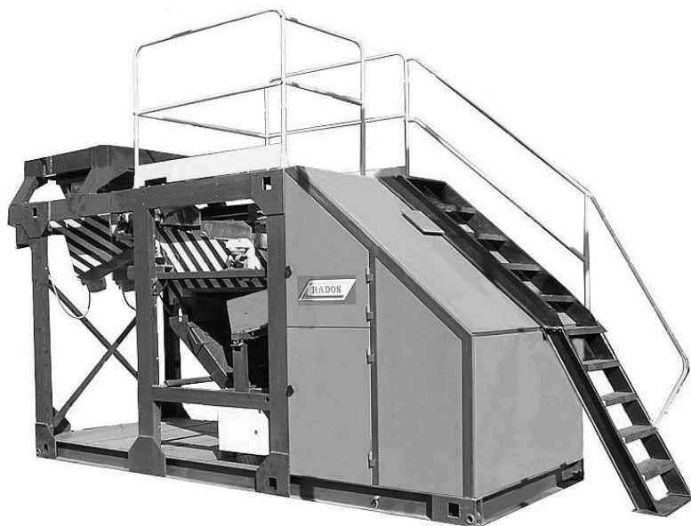
Рис. 4. Внешний вид рентгенометрического (рентгенофлуоресцентного) сепаратора СРФ 4-150
