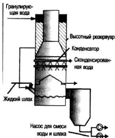
Рис. 2. Схема башни для грануляции шлака [7]
