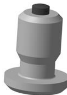
Рис. 1. Конструкция двухфланцевого шипа противоскольжения
