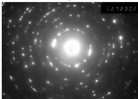
Рис. 3. Микроструктура стали 20 после РКУП в улучшенном состоянии, \times 30000 : а – светлопольное изображение; б – темнопольное изображения в рефлексе 110_{\Phi} («подсвечивает» карбидный рефлекс); в – электронограмма с изображенного участка
