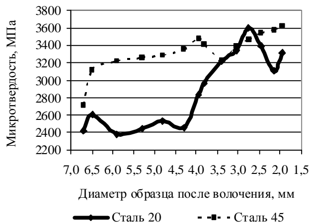
Рис. 11. Изменение твердости при волочении наноструктурированных сталей
