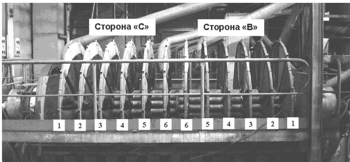
Рис. 3. Схема отбора проб на дисковом вакуум-фильтре ДТВО-100-2.58: 1, 2, 3, 4, 5, 6 – номера секторов
