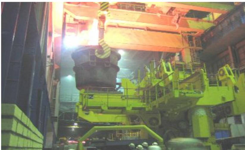
Рис. 1. Г-образный стенд сталеразливочного ковша
