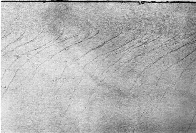
Рис. 1. Внешний вид дефекта «излом»
