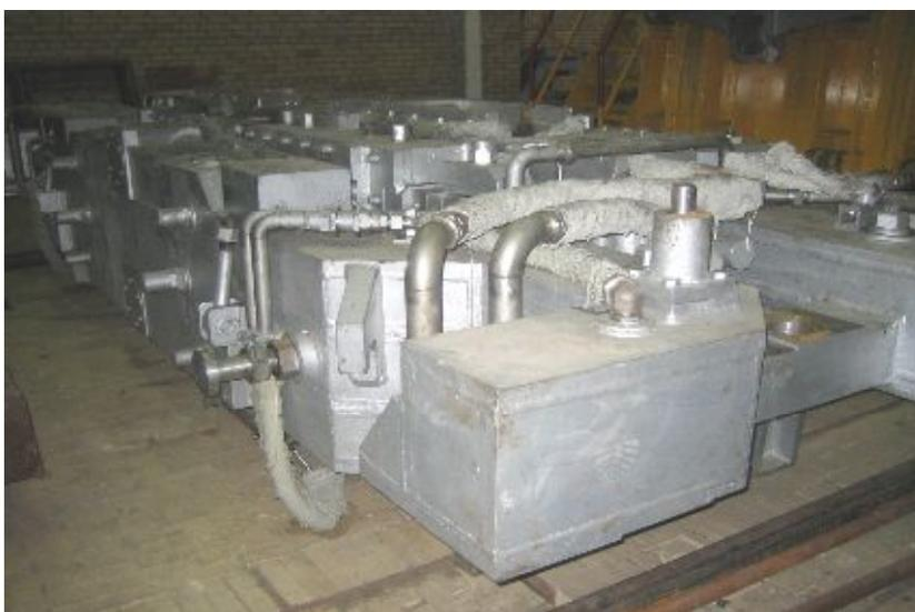
Рис. 2. Вертикальный кристаллизатор МНЛЗ № 5
