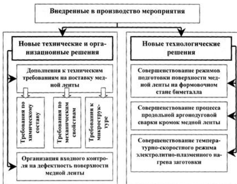
Рис. 3. Структурная схема комплекса организационных, технических и технологических мероприятий, обеспечивающих повышение качества соединения компонентов сталемедной катанки
