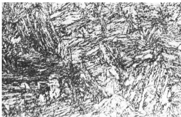
Рис. 1. Микроструктура листов стали 10ХН2М; ×370
