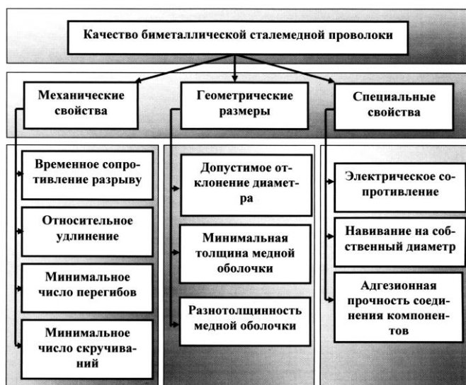
Рис. 1. Структура качества сталемедной проволоки
