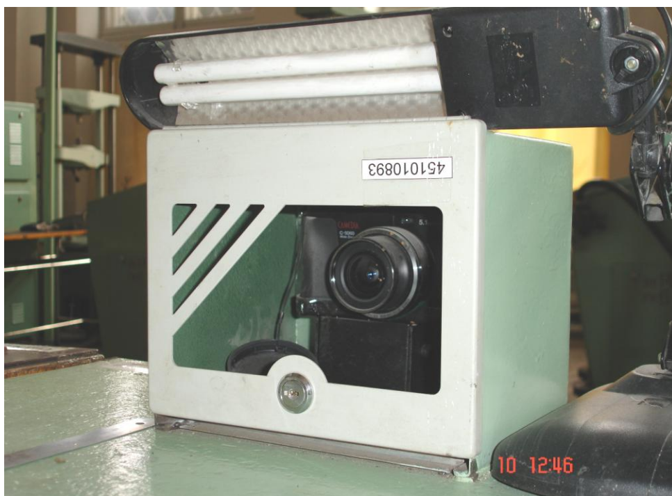
Рис. 2. Установка цифрового фотоаппарата на рабочем месте технолога
