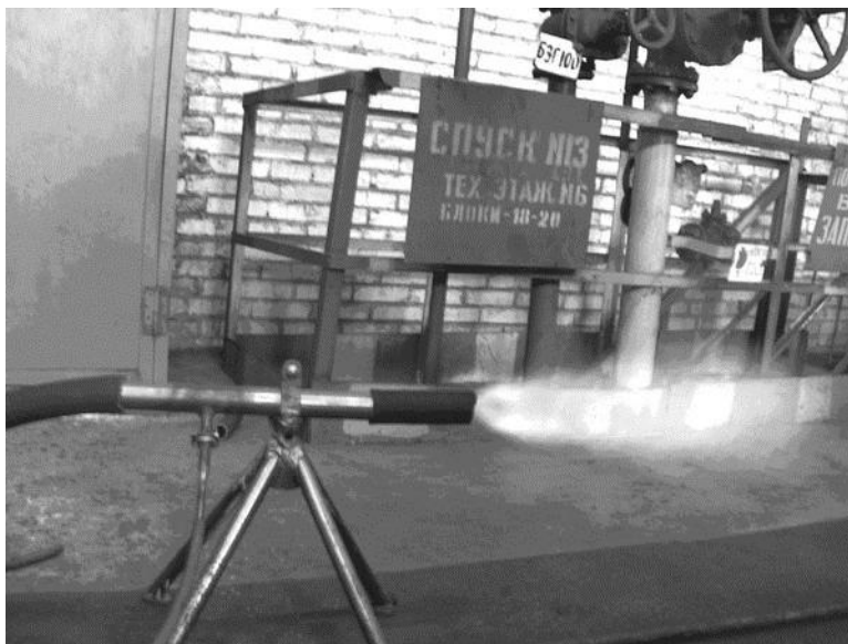
Рис. 4. Устойчивое горение при номинальных расходах топлива и воздуха
